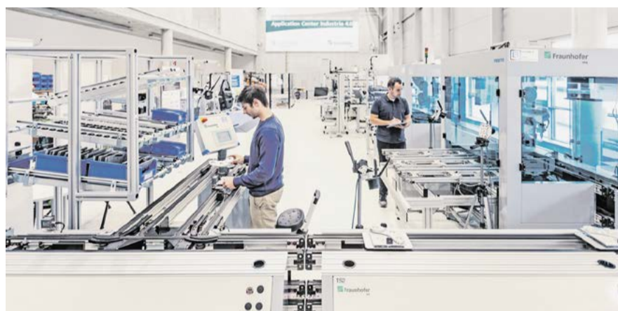
Bei der „Smarten Systemanalyse und -optimierung“ zeichnen Kameras die relevanten Prozessmerkmale in verketteten Anlagen auf. Auf dieser Basis ermittelt die Anwendung die wichtigsten Fehlerquellen und zeigt deren Ursachen auf.
