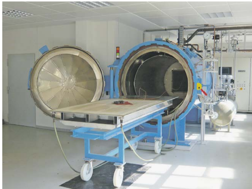
Im Autoklav müssen Faserverbundbauteile bei 200° Celsius und Drücken bis 8 bar über Stunden aushärten. Ein Transponder soll dies künftig überwachen. Foto: Haindl Kunststoffverarbeitung
